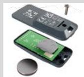
Alimentazione con batteria a 3V
