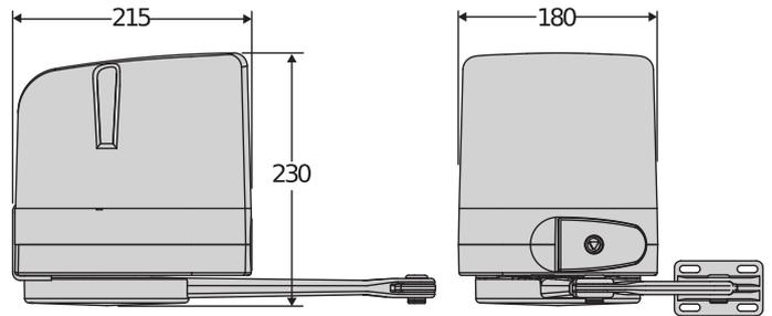
Elektromechaninis valdiklis su lankstiniu petimi, skirtas naudoti gyvenamosiose zonosse atveriamiesiems vartams iki 2 m pločio ir 200 kg svorio. Ideali piemėrots visām uzstādīšanas situācijām, arī uzstādīšanai uz lieliem stabiem. Valdiklyje yra valdymo blokas, ribojimo jungikliai ir mechaniniai stabdžiai.
