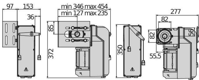
Elektromehāniskais motors vidēji intensīvai lietošanai, rūpnieciskiem sekciju tipa vārtiem līdz  $25\text{ m}^2$  (Pegaso B CJA 625) vai līdz  $45\text{ m}^2$ . Maksimālais atvēršanas ātrums 24rpm un maksimālais griezes moments 70Nm (Pegaso B Cja625); maksimālais atvēršanas ātrums 24rpm un maksimālais griezes moments 100Nm (Pegaso B CJA 645).
