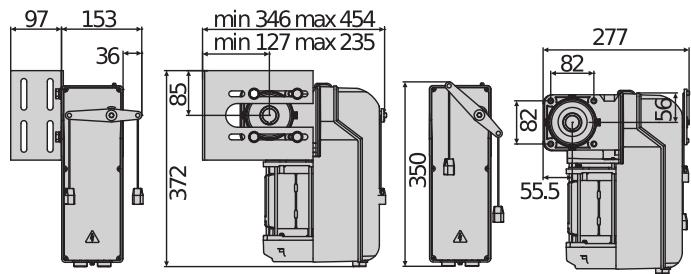
Elektromehāniskais motors vidēji intensīvai lietošanai, rūpnieciskiem sekciju tipa vārtiem līdz  $25\text{ m}^2$  (Pegaso B CJA 625) vai līdz  $45\text{ m}^2$ . Maksimālais atvēršanas ātrums 24rpm un maksimālais griezes moments 70Nm (Pegaso B Cja625); maksimālais atvēršanas ātrums 24rpm un maksimālais griezes moments 100Nm (Pegaso B CJA 645). Galaslēdži ar apgriezenu skaitītāju un iespēju regulēt tos no zemes.
