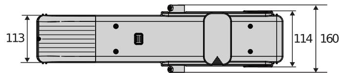
Elektromechaninis gyvenamuosiuose namuose naudojamas valdiklis, skirtas naudoti su automatinėmis pakeliamų garažo vartų sistemomis. Iebūvėts vadības bloks, kas savienots ar otru motoru un vada to , uzstādīšanai uz liela izmēra vārtiem vai vārtiem ar integrētām gājēju durvīm. Mikroprocesora tehnoloģija vada motoru griezes momentu ar maksimālu precizitāti un drošību.
