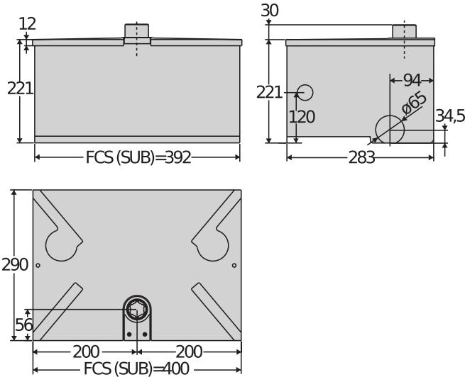
Zemsprieguma pazemes hidrauliskie motori ļoti intensīvai lietošanai, piemēroti jebkura teritorijām. Kompakts un izturīgs, piemērots veramajiem vārtiem līdz 3,5 metrus platumā un svarā līdz 800 kg. ELI 250 un SUB BT slēdzene ar personalizēto atslēgu.
