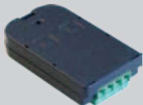
Transmisor bicanal de 433 MHz para asociar al receptor MIME AC (no incluido). Por sus dimensiones miniaturizadas, este transmisor alimentado con pilas se instala fácilmente en las cajas eléctricas murales de las viviendas. La regleta de bornes integrada permite conectarlo a los interruptores de luces o persianas ya presentes en la instalación eléctrica. No es necesario pasar ningún cable por las paredes para controlar los dispositivos.
